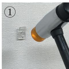
石膏ボードの場合はびったりフックを針で3か所打込みます。木壁の場合は付属の木ネジを1か所ドライバーでねじ込みます。
