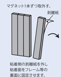
粘着側の剥離紙を外し粘着面をフレーム等の裏面に固定させます。
